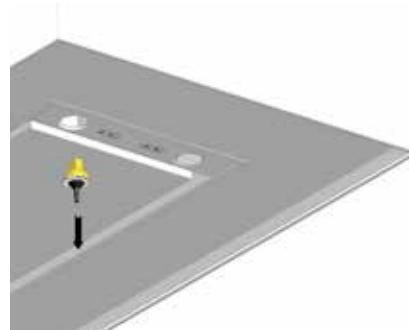
De afzuigkap heeft 4 halogeenspots van 12V/20W/ Ø35/GU4/38°.
